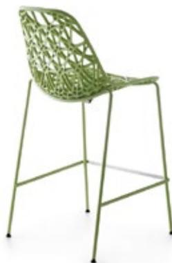
**Structure:** 4L 4 pieds, structure en tube de acier haute résistance, 14mm épaisseur 2 mm. Finition laquée. Traitement de cataphorèse pour usage en extérieur.
