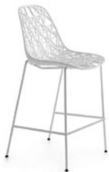
**Structure:** 4L 4 pieds, structure en tube de acier haute résistance, 14mm épaisseur 2 mm. Repose-pieds en profilé d'acier. Protection en inox sur demande. Finition laquée ou chromée. Traitement de cataphorèse pour usage en extérieur.
